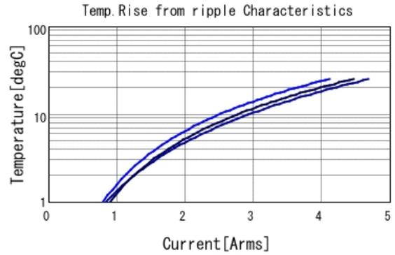
■ KCM55WR71J226MH01 Temp. rise ■ 50kHz ■ 100kHz ■ 300kHz
