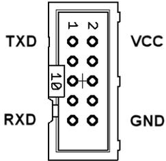
ERFOS-PROG-S2 dient als USB/Seriell-Wandler zum Debuggen der angeschlossenen Schaltung mit einem Terminalprogramm.
