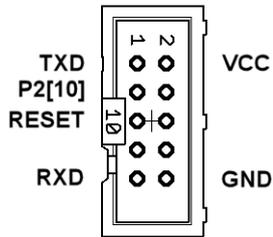
Verbinden Sie die Leitungen des Programmieranschlusses auf dem PROG-S2 direkt mit den Pins am Controller:
